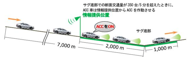
図 7 サービス提供時のシミュレーション上での車両挙動
